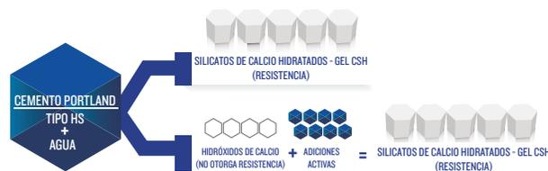
Reacción química de la resistencia a los sulfatos (salitre), debido a la presencia de una adición activa.
